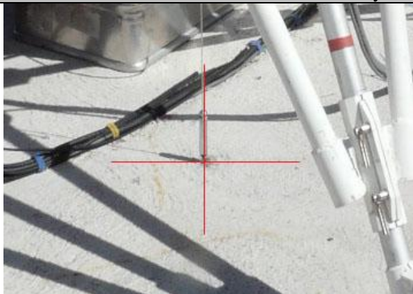
Repère hexagonal en laiton à tête bombée dans le laser pad en béton n° CDP 7822
